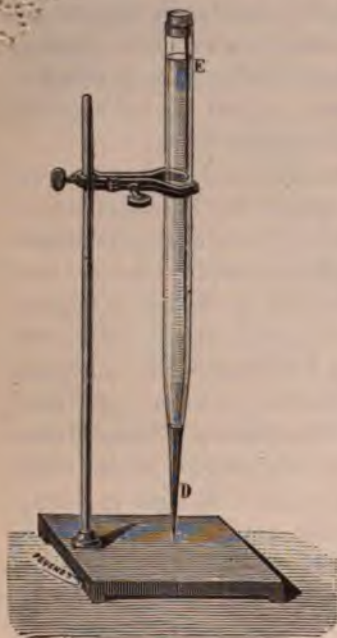
Fig. 44. — Petit appareil pour recueillir les matières en suspension dans les eaux.
